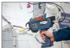
Autotool CPK hybrid con alimentatore e supporto sospeso.
